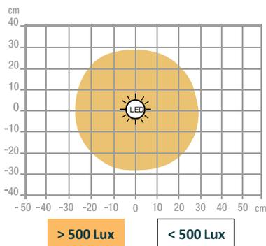
Mesure en Lux sur le plan de travail en vue de profil à 35 cm:
