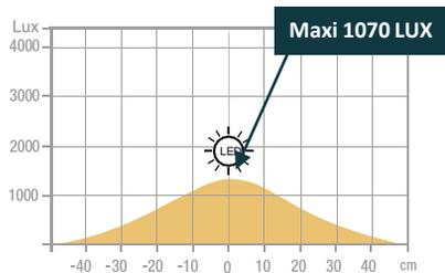
Mesure en Lux vers le haut à 55 cm de la source lumineuse:
