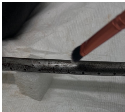
Figure 34 : Application du vernis sur le métal ferreux
