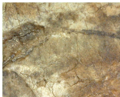
Figure 22: craquèlement de l'étiquette et jaunissement (x250)
