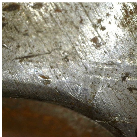
Figure 18: Rayures d'usure sur le métal
