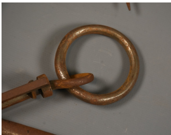
Figure 16: Déformation de l'anneau
