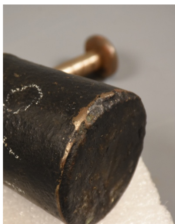
Figure 17: Usure du revêtement
