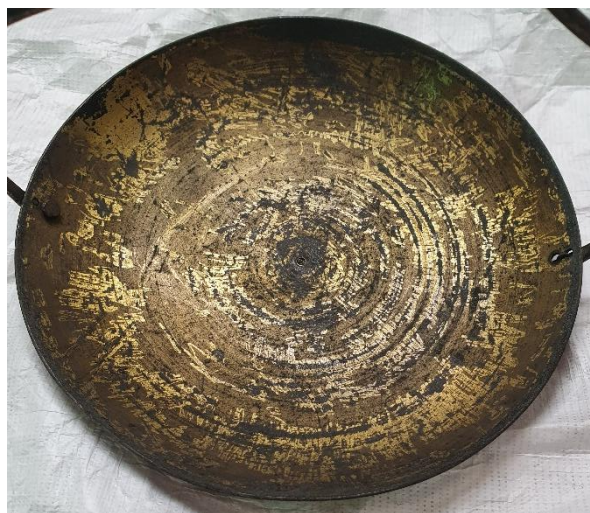
Figure 28 : plateau (1) après passage au stylo à l'ultrasons
