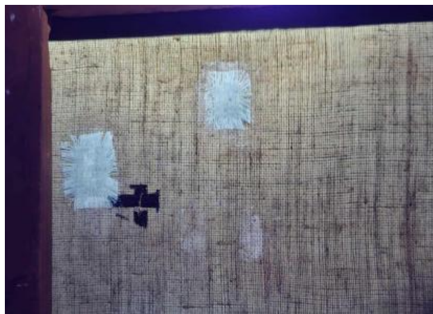
Pièces de renforts sous lumière UV, avec des traces d'adhésif fluorescent à proximité
