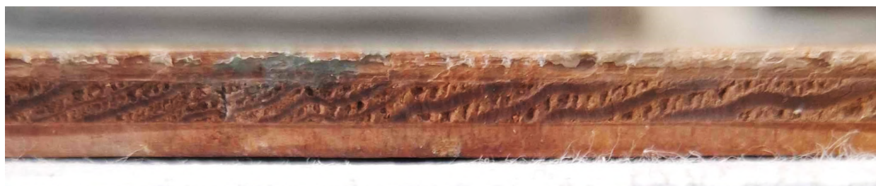
Chant sénéstre : vue des trois plis composant le contreplaqué
