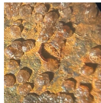
Figure 16: cloque écaillée à la surface de l'objet (x250)
