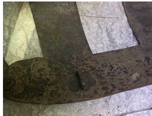
Figure 23: Aspect de surface après la sableuse
