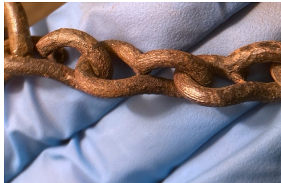
Figure 26: état de la chaîne après nettoyage au cavitron
