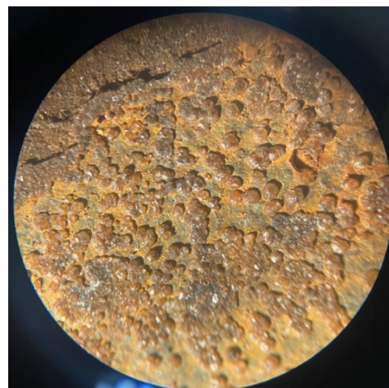
Figure 17: Cristaux présent à la surface de l'objet (x50)
