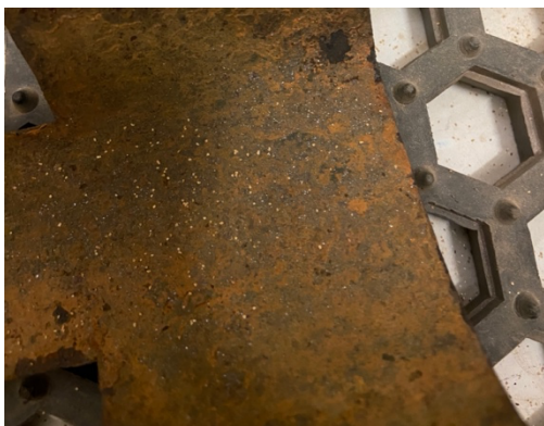
Figure 24: Aspect de surface avant l'action de la sableuse
