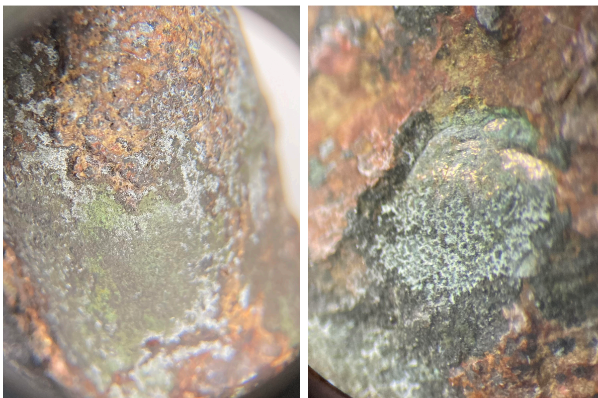
Faciès 4 vu à la loupe et au binoculaire, en dessous de cette fine couche noire on peut facilement voir le métal sous-jacent.
