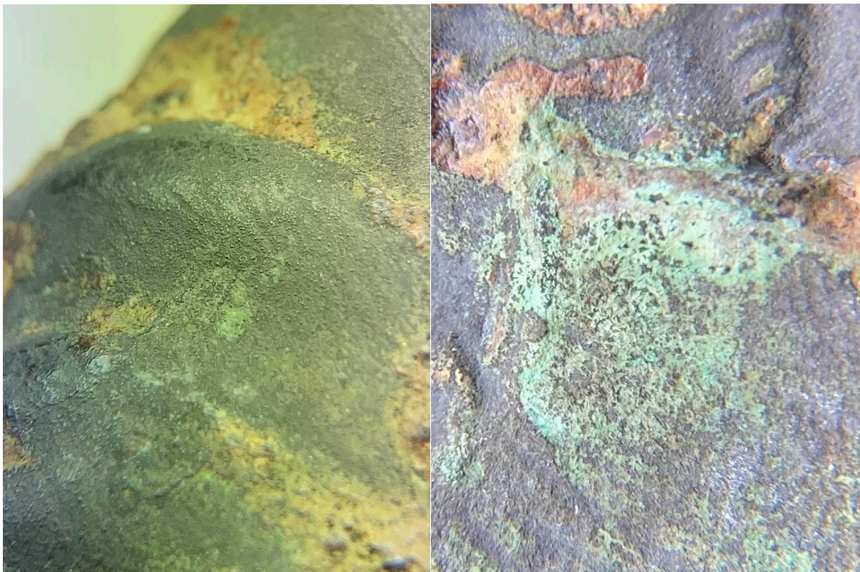
Faciès 2, Vert plus ou moins clair présent par plaques à la surface de l'objet. Produits de Corrosion 2 (verts) visibles sur PdC 1 (noirs)
