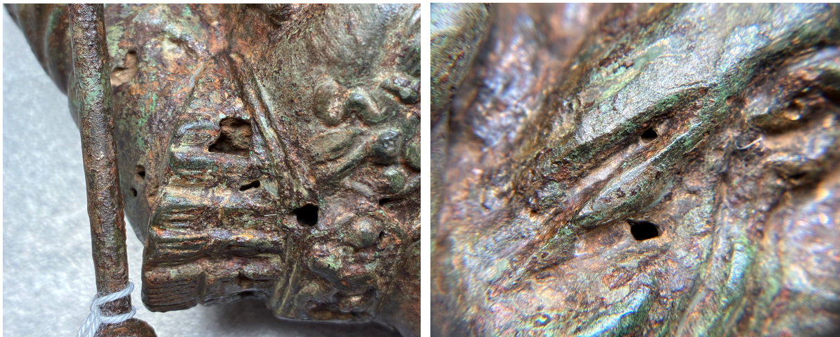
Vues de détail des défauts de coulée. Œil nu et loupe x3.
