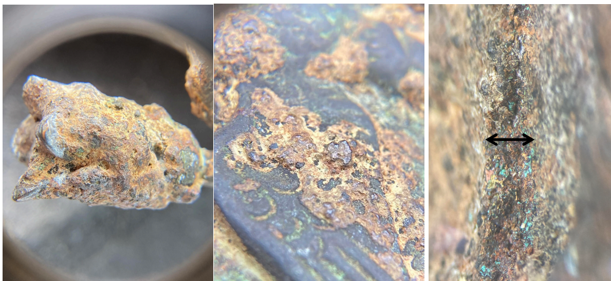
Faciès 3 épais, plus fin, vu sous binoculaire en coupe (après retrait d'une partie)
