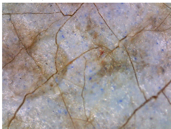
photographie sous microscope portable du montant senestre : traces de colle de refixage
