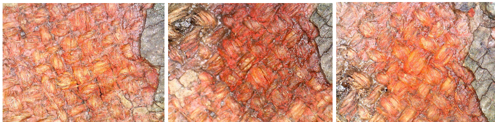
photographie sous microscope portable : zone de test de sensibilité à l'eau (tranche inférieure) : avant humidification, après humidification, après humidification et frottements
