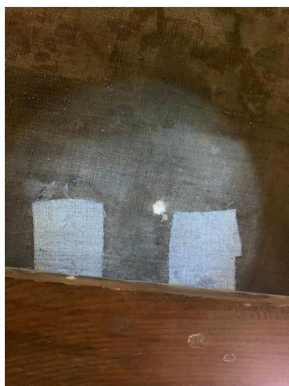
photographie sous UV : mise en évidence de colle animale avec la fluorescence
