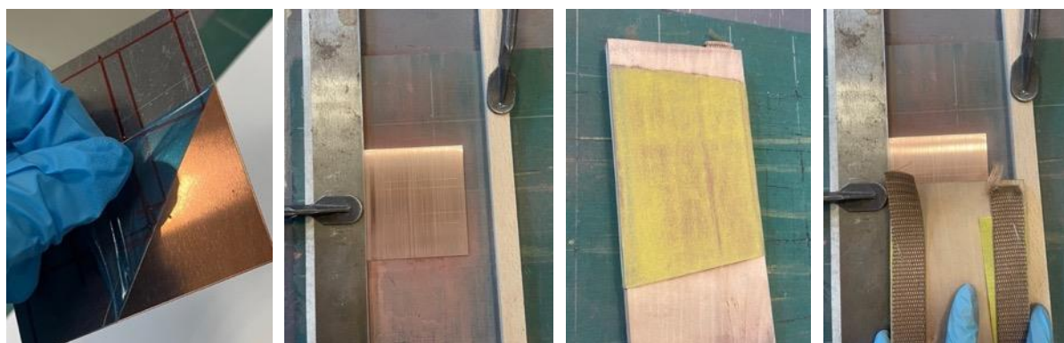
A. RETRAIT DU FILM DE PROTECTION, B. MISE SOUS SERRE-JOINT, C. CALE EN BOIS COUVERTE DE PAPIER ABRASIF, D. PONÇAGE LE PLUS DROIT ET REGULIER POSSIBLE.
