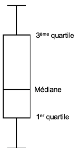
FIGURE 104 COMPOSITION D'UN DIAGRAMME DIT « BOITE A MOUSTACHE » © GAËTAN GUILLOD
