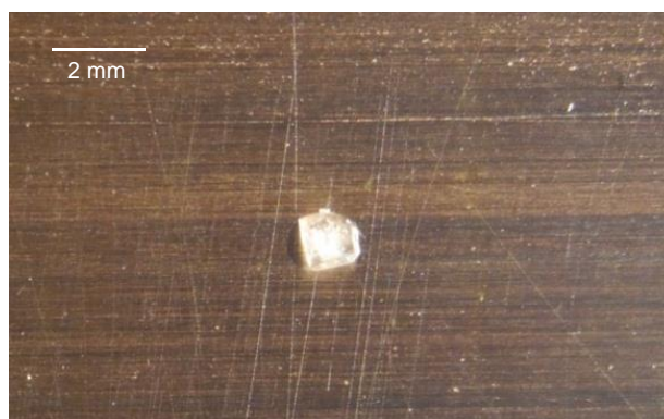
FIGURE 98 EXEMPLE DE CRISTAL DE SEL RESIDUEL APRES SECHAGE DE LA SOLUTION DE CORROSION SUR LA RESINE (T=24H)
