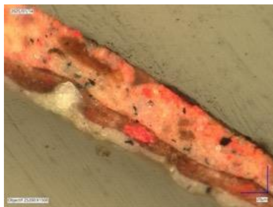
FIGURE 29 COUCHE STRATIGRAPHIQUE DE L'ECHANTILLON INP2024102P02 EN LUMIERE POLARISEE
