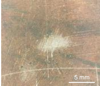
FIGURE 42 ZONE BRILLANTE DU REVERS VUE A LA LOUPE BINOCULAIRE
