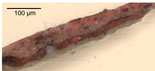
FIGURE 51 COUPE STRATIGRAPHIQUE EN LUMIERE DIRECTE, ECHANTILLON INP2024102P02, SOUS-COUCHE GRISE VERS LE BAS
