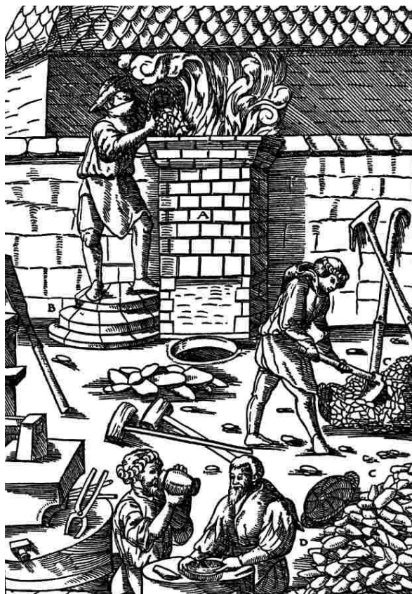
Fig. 1 : Agricola, bas fourneau, système à réduction directe (XVI e s.)
