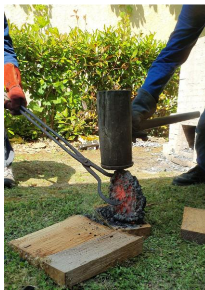
Fig. 14 : La loupe compactée à l'aide d'un persuadeur
