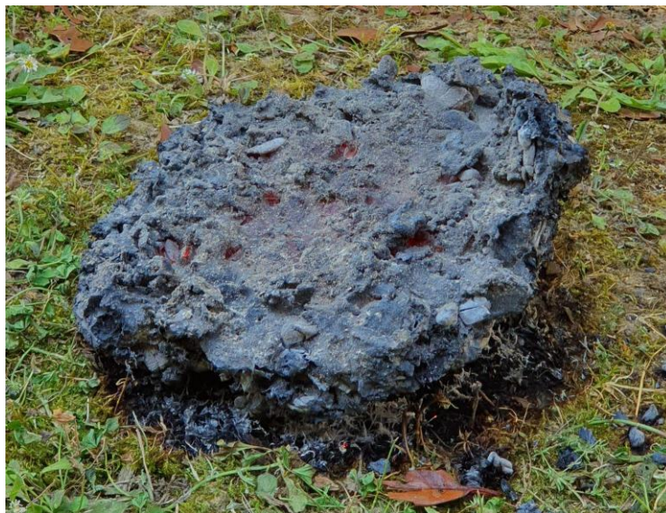
Fig. 16 : Loupe de fer après refroidissement
