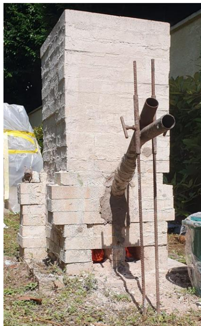
Fig. 9 : Les trous de sorties de scories encore ouvert avant bouchage
