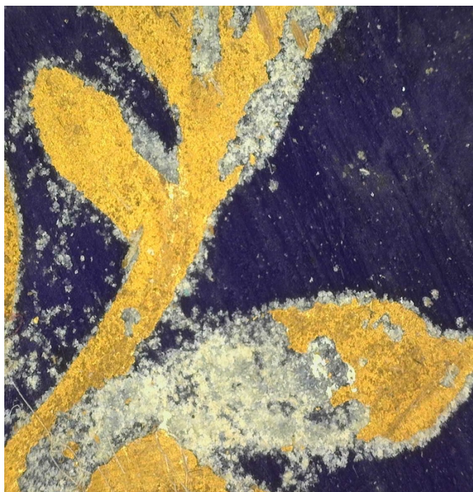
Fig. 58 : Couche blanchâtre sous la dorure, vase Musique, sous Dino Lite®, x50
