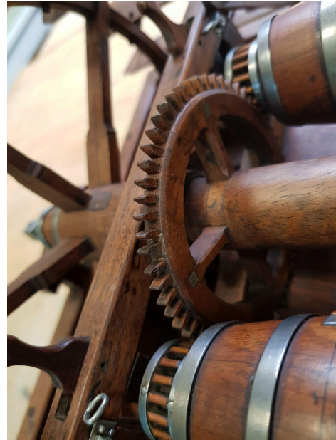
Figure 42 Mise en place d'une dent restituée sur l'engrenage
