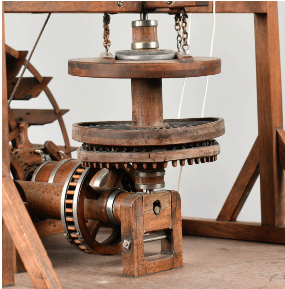
Figure 13 Axe des meules gisante et tournante
