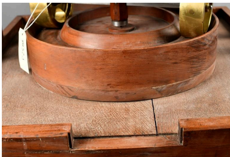
Figure 29 Ouverture du joint des panneaux du socle
