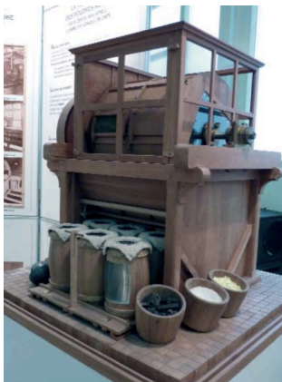
Maquette d'une tonne de trituration. © Musée de la poudrerie de Sevrans-Livry La tonne de trituration est entourée d'un châssis muni d'une toile métallique et d'un tamis pour trier le mélange après trituration.
