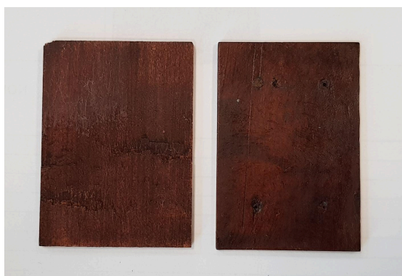
Figure 54 a Gauche : aube restituée teinte / droite : aube d'origine
