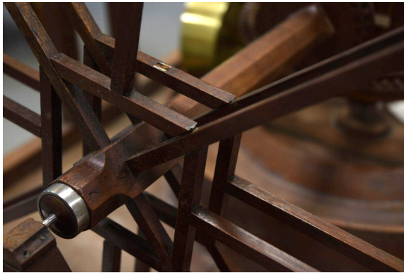
Figure 20 Arbre principal et centre de la roue à aubes
