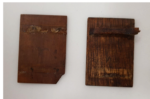
Figure 19 Aubes en Prunus sp. (gauche) et en bois exotique (droite)
