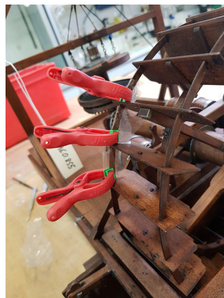
Figure 40 Collage des éléments restitués
