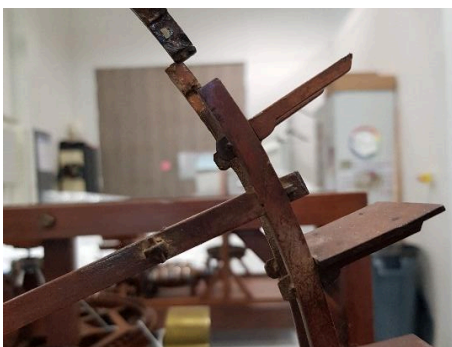
Figure 18 Support d'aube fixé par une clé
