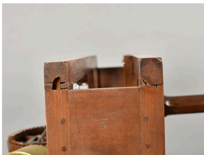
Figure 34 Extrémité de la traverse droite partiellement lacunaire et fente
