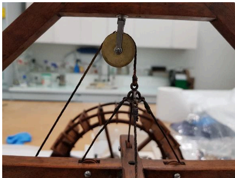
Figure 15 Système d'accroche par poulies
