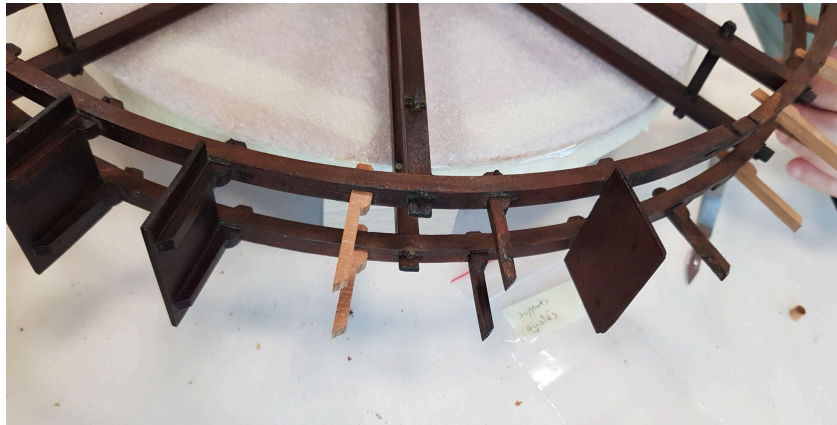
Figure 55 Adaptation des tenons des supports à leur emplacement
