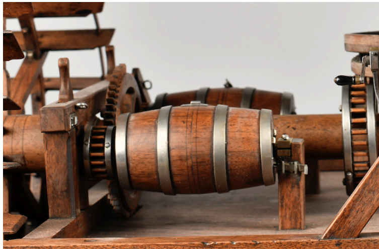
Figure 9 Arbre principal, engrenage, tourtes et tonneau
