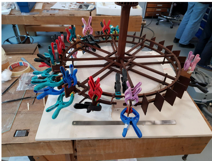
Figure 57 Collages des aubes sur leurs supports
