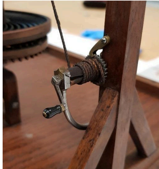
Figure 14 Manivelle à rochet
