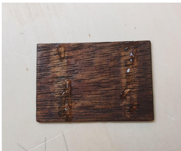
Figure 47 Application du gel de laponite pour retirer la colle persistant après le clivage
