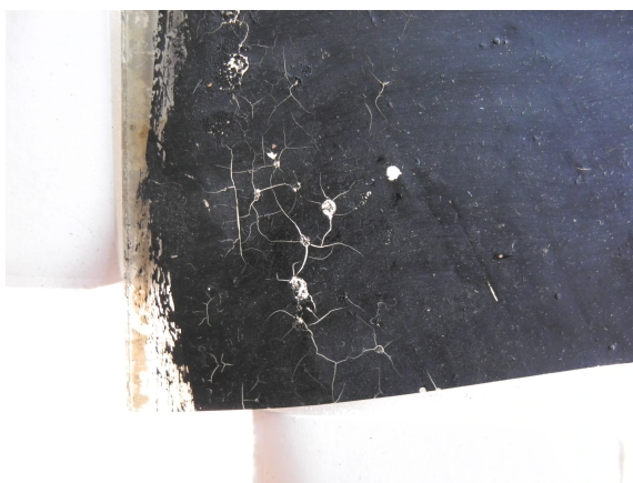
Craquelures du vernis en lumière transmise (partie supérieure de la plaque, verso, coin inférieur gauche)
