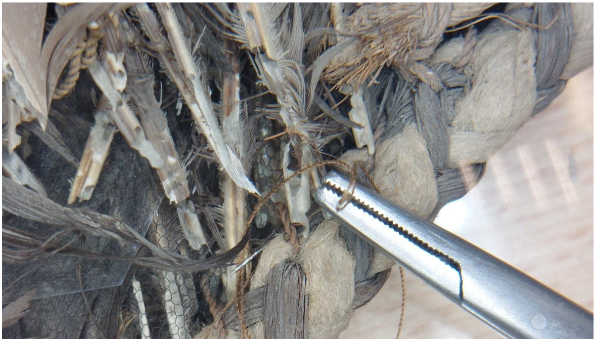
Fig.40-Vue sous loupe, de la réalisation d'un nœud autour d'une corde :ençant le tulle du bandeau de tête
