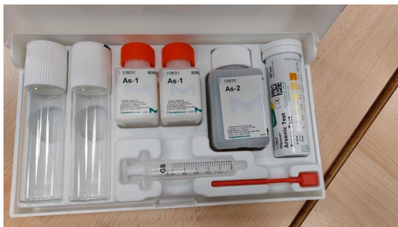
Fig.29- Kit de spot test de l'arsenic
