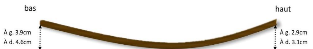
Ci-dessus : schéma détaillant la courbure du panneau
