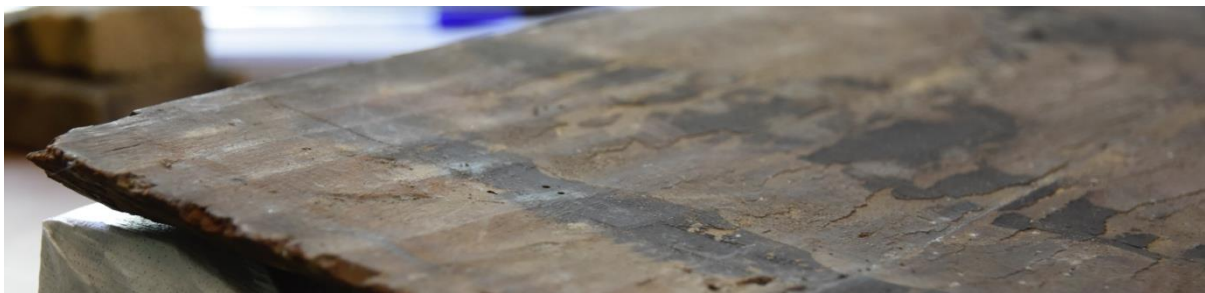
Fig. 23 : Face du bois non retravaillée après le passage de la gouge.
