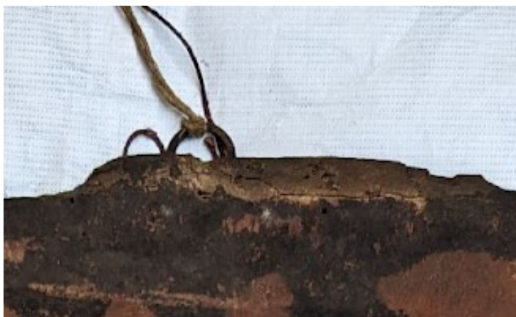
Bois fendu au niveau de l'anneau métallique
