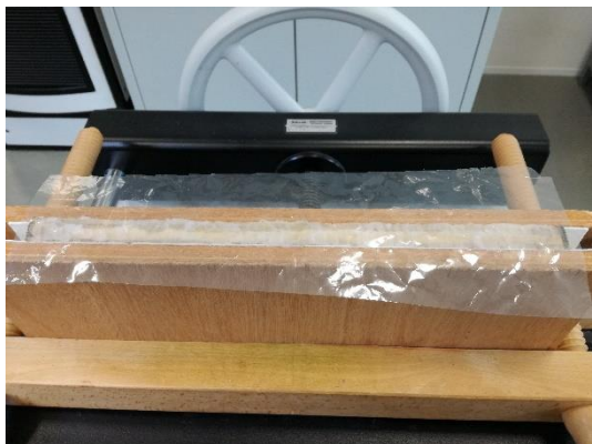
Fig.34 : Livre maintenu dans un étau, dos recouvert d'un cataplasme et d'un coupon de mylar®
