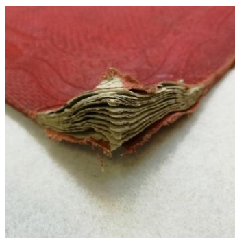
Fig.41 : Couche de délamination séparées à sec
