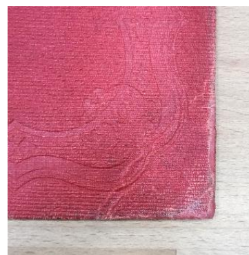
Fig. 45 : Résultat d'un comblement de lacune avec le matériau texturé réalisé
