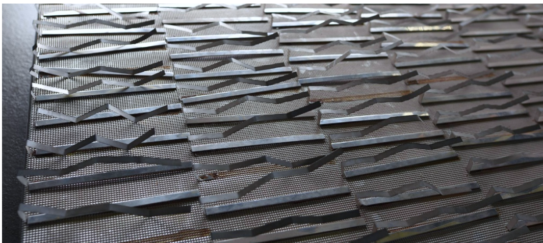
Figure 9 : Déformations hétérogènes des lamelles, rendant la lecture illisible.
