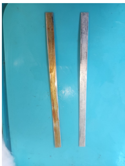
Figure 16 : Exemple de plaque, avant et après retrait de la colle.
