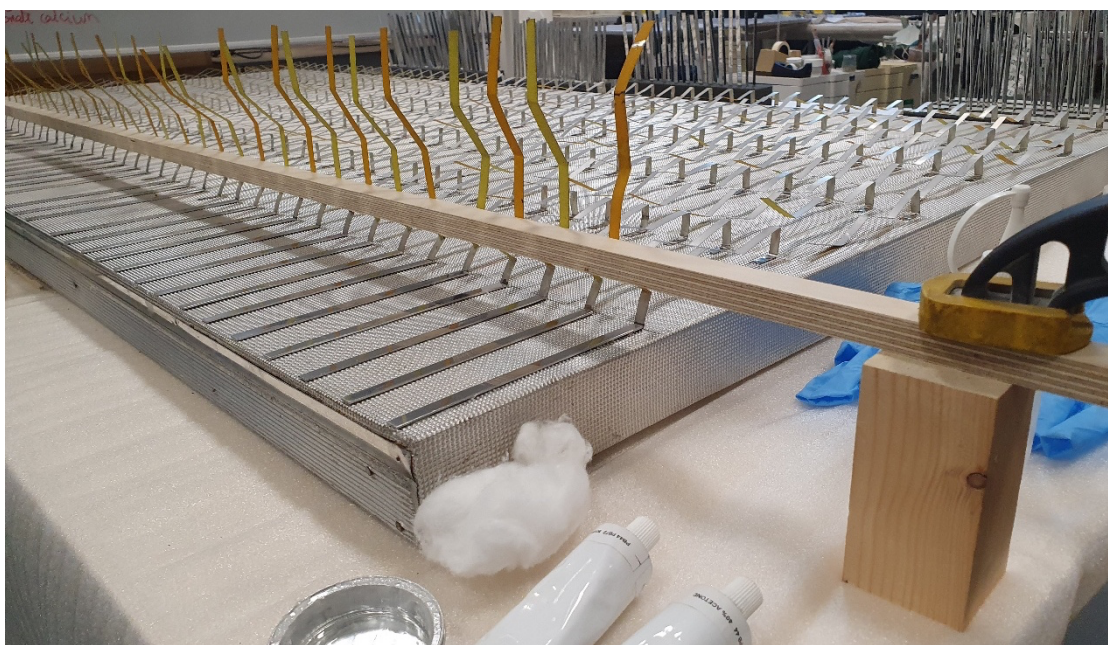
Figure 19 : Système pour soulever une ligne de lamelles en une seule fois.
