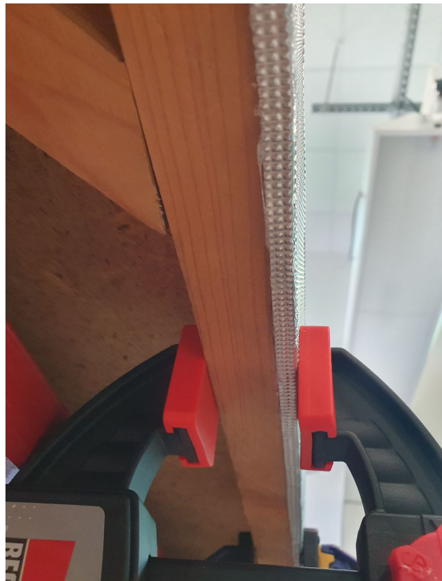
Figure 32 : système de maintien lors de la prise de la colle.
