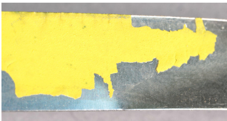
Figure 8 : Écaille de peinture sur une lamelle.
