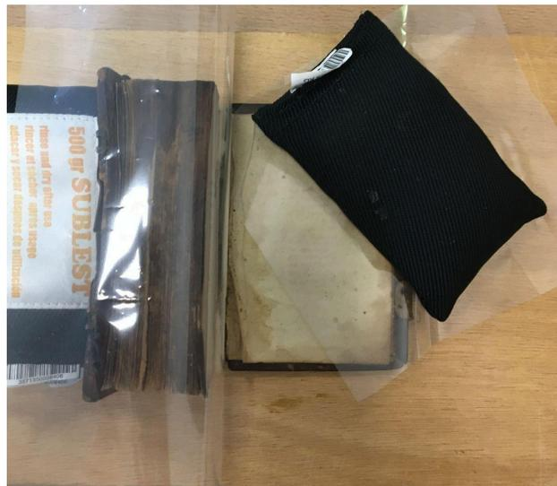
Figure 29 - Protection de surface pour une humidification progressive
