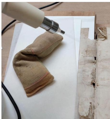
Figure 15- Humidification au micro nébuliseur à ultrasons
