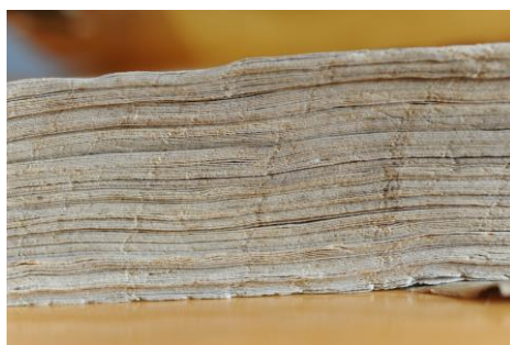
Figure 64 : Trace de l'outil de rognage
