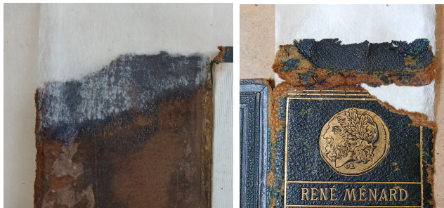
Fig. 13: Doublage et comblement de la zone lacunaire du dos
