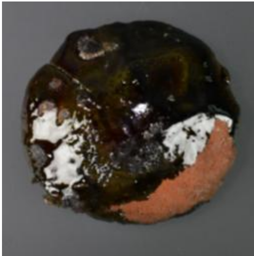
Fig 49-Coupelle fissurée sans perte de matière XP-2023-1-1
