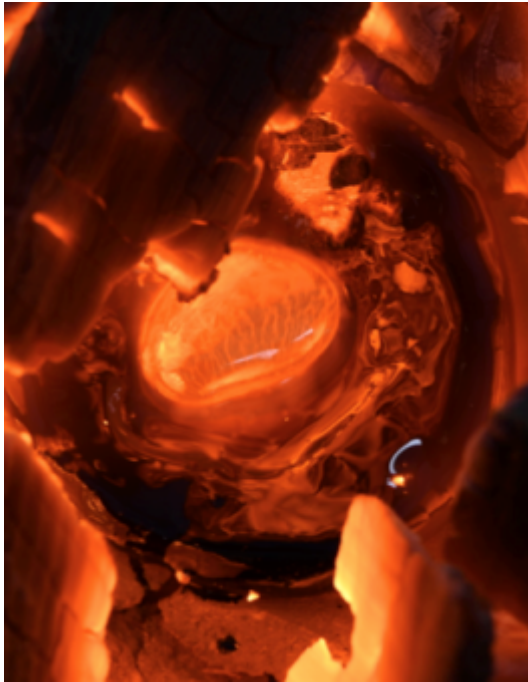
Fig 2 - Oxydes sortant du bouton en fusion et se déposant dans la coupelle
