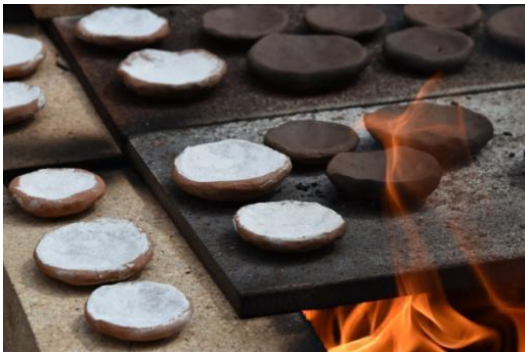
Fig 22 - Coupelles avec ou sans cendre d'os en cours de préchauffage
