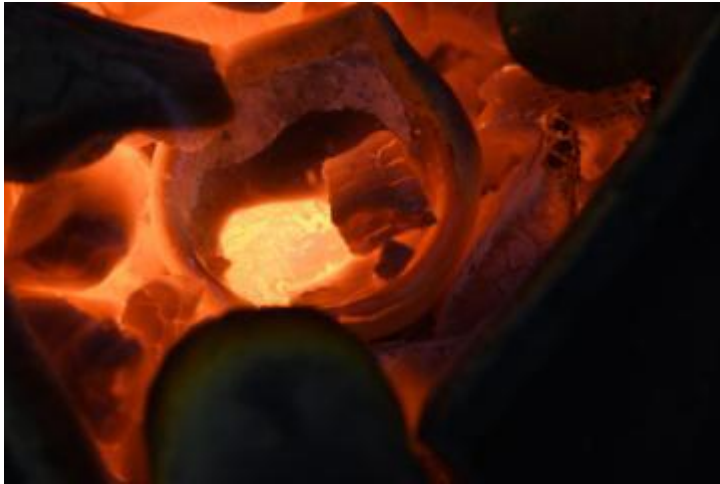
Fig 29 - Ici le creuset s'est fissuré, le métal est en train de couler progressivement, il faut donc arrêter l'opération pour ne pas perdre tout l'alliage
