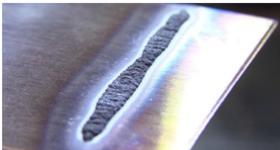
Fig 59 - Rochage d'une soudure
