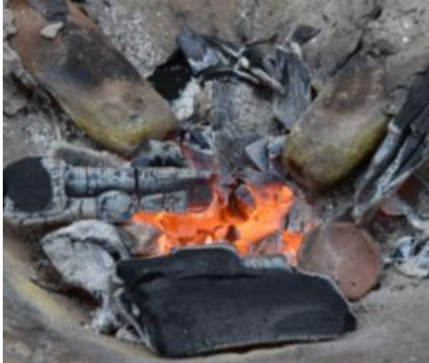
Fig 24 - Préchauffe d'une coupelle
