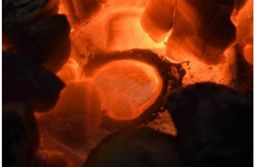
Fig 27 - Bouton en fusion, avec oxydes à la surface
