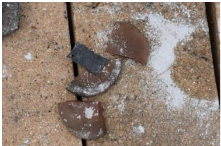
Fig 28 - Exemple de coupelle ayant explosé dans le four
