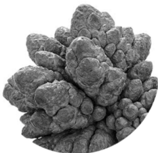
Fig 60 - Plomb formé par électrodéposition
