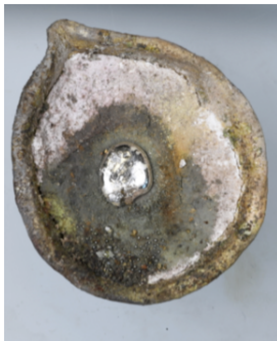
Fig 9 - Creuset rempli de cendre d'os (XP-2023-20-1)
