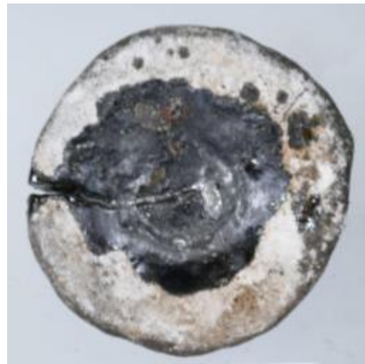
Fig 50-Coupelle fissurée avec perte de la prise XP-2023-10-1
