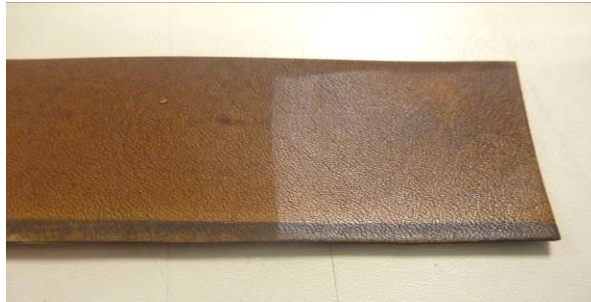
18 Cuir teint avant et après application de Paraloid B72
