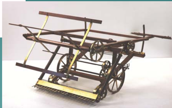
Maquette de faucheuse-moissonneuse poussée, Patrick Bell, 1825
